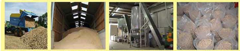
1 Resatura, trasporto e stoccaggio del cippato verso lo stabilimento di produzione (verranno utilizzati degli spazi coperti in modo da non esporli agli agenti atmosferici) 2 Essiccazione del cippato (da valutare il possibile recupero degli essiccatori esistenti) 3-4 Processo di produzione (dall'essiccazione, pelletizzazione, raffreddamento, insaccamento, ecc...)
